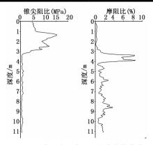
图 19 锥尖阻力及摩阻比深度变换曲线
