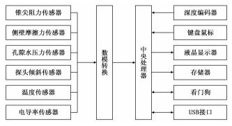
图 1 硬件总体框架图
