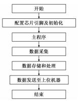
图 3 基带板整体工作软件流程图
