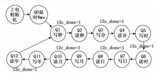
图 3 实时时钟模块状态流程图
