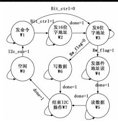
图 4 I2C 读写状态转移图
