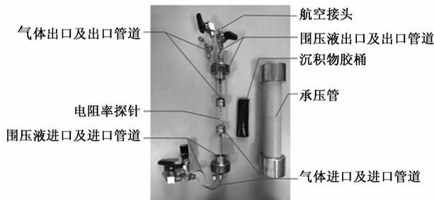
图 2 射线穿透式反应釜
