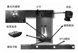
图 2 盾构隧道检测系统
