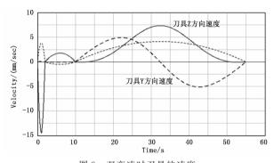
图 9 双变速时刀具的速度
