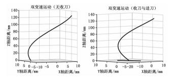
图 11 变速运动有无收刀进刀情况图
