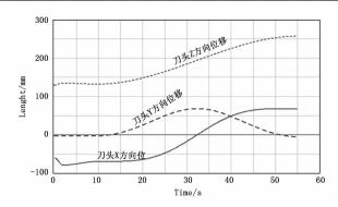
图 8 双变速时刀具的位移
