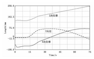
图 7 刀头的位移曲线
