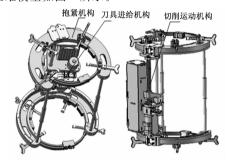
图 2 便携式自动割胶机器人的三维模型
