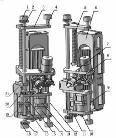
1. 轴端滑套;2. 轴端啮合齿轮 1;3. 丝杠支撑板;4. 随动滑套,5. 滚珠丝杠,6. 控制箱;7. 丝杠螺母座;8. 刀头组,9. 随动轴;10. 小齿轮;11. 传动齿轮;12. 随动轴;13. 步进电机;14. 减速器;15. 中间轴;16. 传动轴,17. 轴端啮合齿轮 2;18. 轴端滑套;19. 二级啮合齿轮 1;20. 二级啮合齿轮 2;21. 遮挡板.
