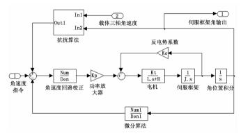
图 3 光电成像系统稳定控制回路图
