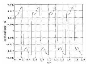
图 4 光电成像系统航向稳定精度测试曲线
