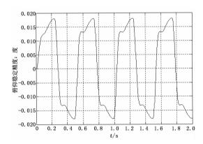
图 5 光电成像系统俯仰稳定精度测试曲线
