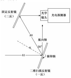
图 1 光电成像系统光路与框架轴关系示意图
