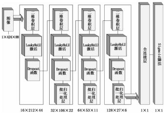
图 3 DCGAN 模型判别网络结构图
