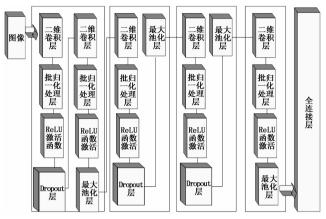
图 1 改进的 AlexNet 模型结构图
