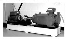
图 1 美国凯斯西储大学 (CWRU) 电机一轴承试验台
