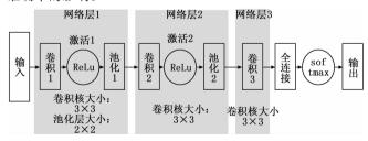
图 1 神经网络模型 MCCN 结构图
