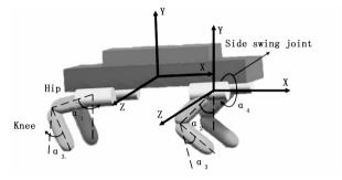
图 3 四足机器人关节运动示意图
