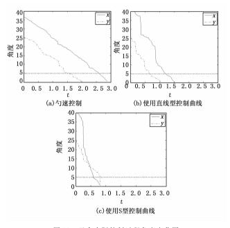
图 11 云台实际控制过程角度变化图
