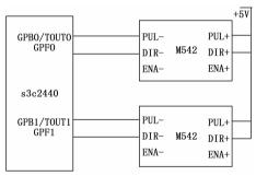
图 2 主控制器与电机驱动器连接图
