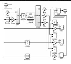
图 5 基于函数模型的变论域模糊 PID 算法仿真子系统
