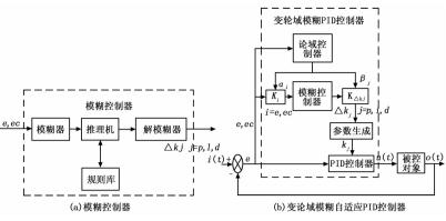
图 3 变论域模糊自适应 PID 算法控制过程
