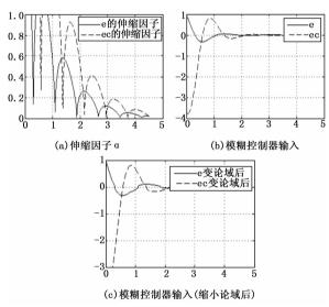
图 7 基于函数模型的缩放型变论域 仿真过程中的重要变量
