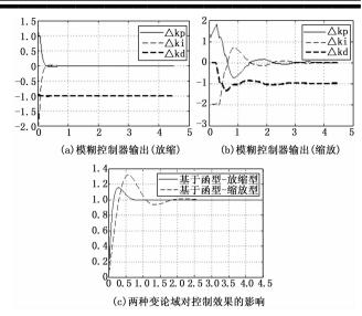
图 8 基于函数模型的放缩型、缩放型变论域的模糊控制器输出及控制效果
