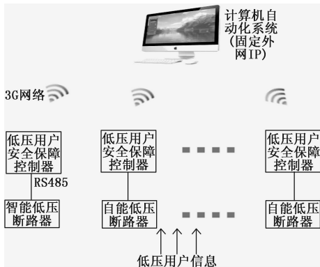
图 1 低压用电客户全方位在线诊断系统的总体架构图
