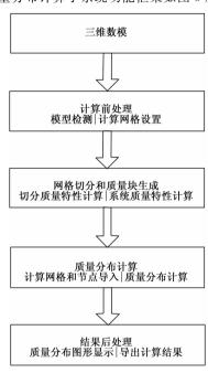
图 5 质量分布计算子系统功能框架
