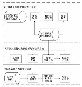
图 2 飞行器质量特性管理系统业务流程
