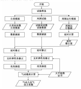
图 1 连续变攻角试验及数据处理流程图
