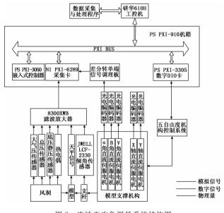
图 2 连续变攻角测量系统结构图
