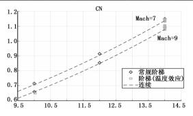
图 7 天平温度效应验证试验结果
