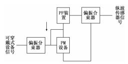
图 2 传感器信号纵波偏振调制原理图
