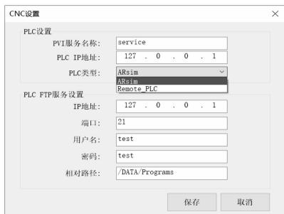
图 7 CNC 连接设置
