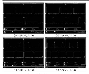
图 6 不同频率的 PWM 波形
