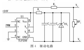
TLP250 光耦合器内置一个 GaAlAs 光发射二极管和一个集成光探测器,采用 8 脚双列封装结构,带光隔离和驱动输出。如图 4 所示,将高频脉宽调制器输出的 PWM 信号输入到 TLP250 光耦合器中,光耦合器外接一个 7.5 V 的稳压管,当 PWM 信号向光耦合器的输入引脚(2、3 引脚)输入高电平时,光耦合器的输出引脚(6、7 引脚)的输出电压被内置的上拉电阻拉高到 24 V。此时,外围电路  $V_G$  引脚的电势为 24 V;当 PWM 信号向光耦合器的输入引脚输入低电平时,光耦合器的输出引脚输出 0 V,外围电路  $V_G$  引脚的电势为 0 V。由于外接稳压管的作用,外围电路  $V_E$
