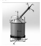
图 5 两自由度水炮运动学模型及坐标系
