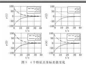
坐标差值变化,可以观察到 4 个特征点最终都趋近为 0,不在变化。以上结果证明 IBVS 方法中误差函数收敛,满足控制理论的要求,可以对绝缘子进行定位后跟踪冲洗提供算法。
