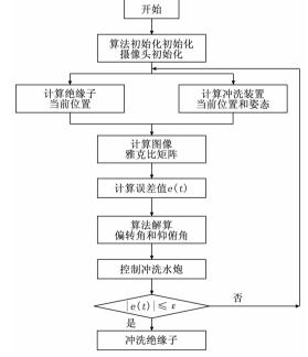
图 3 基于图像伺服控制策略流程图
