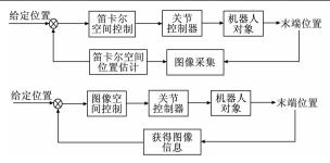
图 2 基于位置的视觉伺服控制结构框图与于图像的 视觉伺服控制结构框图对比
