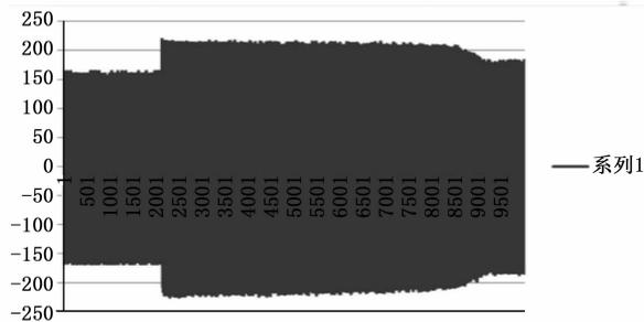
图 12 泵负载启动电流波形图
