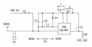
图 2 24 V 转 5 V 降压电路
