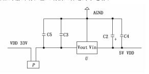
图 3 5 V 转 3.3 V 降压电路
