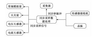
图 4 采集器同步数据处理图
