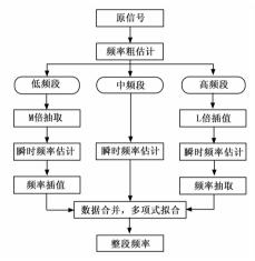
图 5 三段多速率瞬时频率估计方框图
