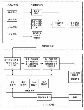
图 2 某型火炮 PHM 结构体系图
