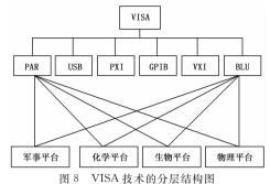
图 8 VISA 技术的分层结构图
