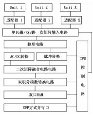
图 3 虚拟数据采集分析仪工作原理图
