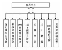
图 1 基于虚拟仪器的 ATS 硬件平台架构
