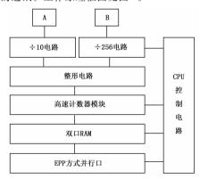
图 5 1 G 频率计/计数器工作原理框图
