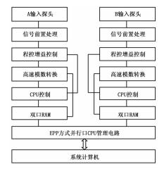
图 4 虚拟示波器工作原理框图
