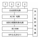
图 2 自动量程多用表电路工作原理图
