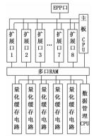
图 9 主控电路工作原理框图
