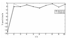
图 7  $Y_E$  方向 (预测一真实) 与 (测量一真实) 轨迹
