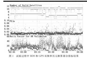
算历元数目只有 995 个,小于同步同时段保存的数据个数,相比之下 BDS 数据仅仅有 40 个无法解算,可以看出在观测条件较差时 BDS 数目仍可以保持较多。对于解算历元而言,BDS 双频模糊度固定成功率(且认为 Ratio 值大于 3 即成功)比双频 GPS 高出约 20 %,且 BDS 的定位误差小于 GPS 的定位误差。对整个过程的解算的 BDS 结果进行 95 %的置信概率统计精度分析,可以得到水平、垂直和三维定位精度如表 2 所示。
