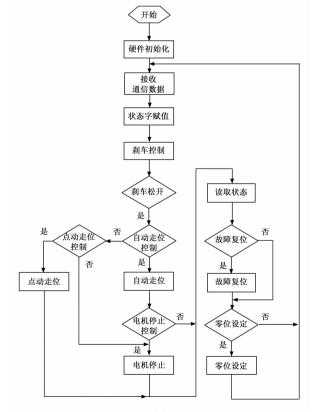
图 4 平台控制系统运动流程图
