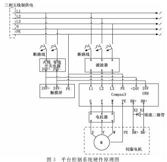
通常情况下,对于 MHA 系列该种自带集成刹车的伺服电机,Compax3 在控制时会将刹车与电机的运动控制联动,即电机停止时刹车自动抱紧,运动时则自动松开,而在失电时刹
