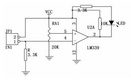
图 6 比较型传感器电路图
