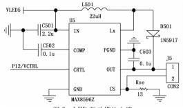
图 7 LED 驱动模块电路
