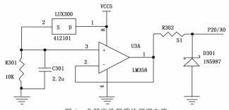
图 4 光照度检测模块调理电路
