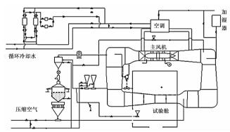
图 1 砂尘试验风洞简图
