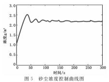
根据专家经验设定好 PID 整定参数,实际的控制效果如图 5 所示。此时为高砂试验,浓度设定值为 2.2 g/m³,风速为 20 m/s,对应的传感器标定参数为 3.74 mA·m³/g。开始时砂尘浓度为 1.1 g/m³,和设定值差距较大,此时专家系统使用规则 1,打开 3 个电机,使用较大的比例系数 (P)。当浓度,达到设定值时,波动较大,超调明显,此时使用规则 3,采用较强的 PID 控制,减少调节时间,快速稳定。波动减小到阀值以后,采用规则 4,使用较弱的 PI 控制,满足控制精度和稳定性的要求。最后使用规则 2,保持 PID 参数不变,浓度被控制在 2.2 g/m³,且能保持长时间稳定。
