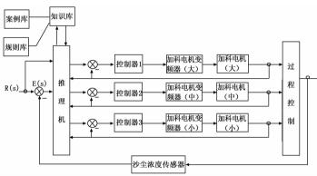
图 4 基于专家 PID 的砂尘浓度控制系统结构图
