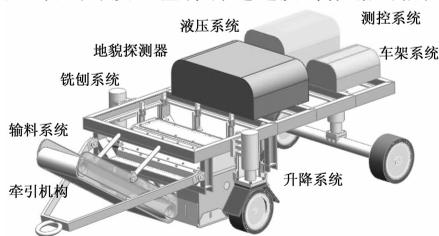
图 1 机械布局结构示意图
