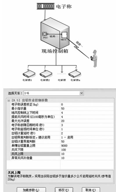
图 6 现场获取的 PLC 控制参数
